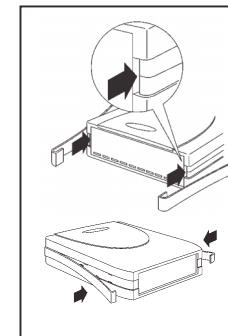
*Setzen Sie die Gehäusehälften wieder zusammen und haken Sie die Gehäuseschienen an der Frontblende ein. Drücken Sie die Gehäuseschienen von vorne nach hinten vorsichtig in die vorgesehenen Aussparungen bis Sie an der Rückseite einrasten.*
