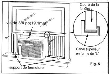
Coupez la bande mousse adhésif afin qu'elle s'ajuste adéquatement à l'ouverture entre le haut de l'intérieur et de l'extérieur de la fenêtre puis fixer le serrure de sûreté sure le cadre du fenêtre extérieur en utilisant une vis de 3/4 po(19.1mm) Voir Fig. 6.
