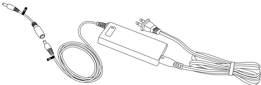
4. Insérez le cordon d'alimentation dans l'adaptateur c.a., puis branchez-le sur une prise de courant.
