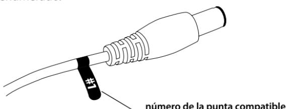
3. Conecte el conector seleccionado al extremo del cable de salida del adaptador de CA.
