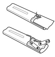
Setzen Sie die Batterien mit dem negativen Pol (–) zuerst ein und drücken Sie sie dann nach unten, bis der positive Pol (+) mit einem Klicken einrastet. Wenn Sie das Batteriefach schließen, achten Sie darauf, den Deckel richtig anzusetzen.
