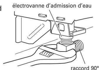
6. Serrer le raccord sans forcer; veiller à orienter la sortie du raccord vers l'arrière.
