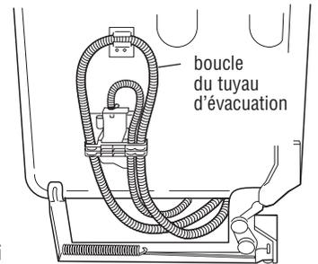
2. Ne pas détacher du lave-vaisselle la boucle formée par le tuyau d'évacuation sur le côté de l'appareil.
