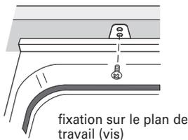
4. Entrouvrir la porte d'environ 7,6 cm (3"); vérifier que l'espace entre la doublure interne de la porte et la cuve est identique des deux côtés. Si l'espace n'est pas identique des deux côtés, desserrer les vis des brides d'arrimage et déplacer légèrement la cuve. Resserrer les vis.
