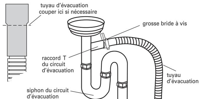
3. Insérer le tuyau d'évacuation à travers le trou découpé dans le placard et acheminer le tuyau jusqu'à l'emplacement de raccordement au lave-vaisselle.
