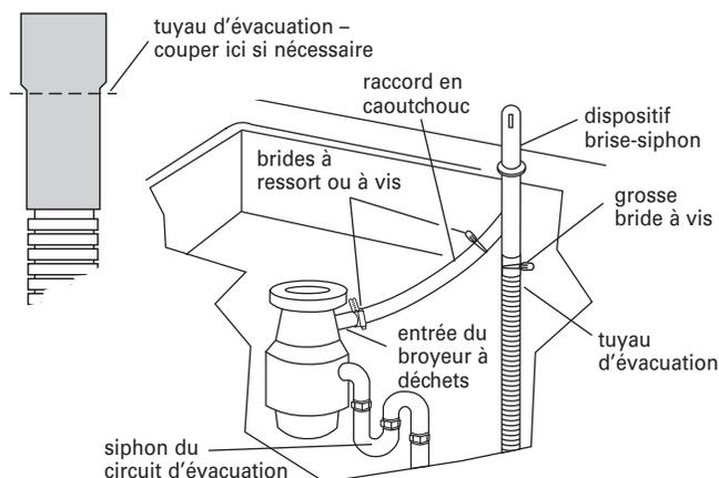
4. Insérer le tuyau d'évacuation à travers le trou découpé dans le placard et acheminer le tuyau jusqu'à l'emplacement de raccordement au lave-vaisselle.
