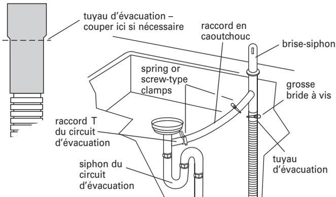
4. Insérer le tuyau d'évacuation à travers le trou découpé dans le placard et acheminer le tuyau jusqu'à l'emplacement de raccordement au lave-vaisselle.
