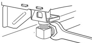
3. Placer une serviette de papier sous le raccord soudé. Ouvrir l'arrivée d'eau et inspecter pour identifier toute fuite.
