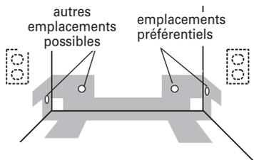
1. Percer un trou de 3,8 cm (1 1/2") dans la paroi du placard ou le mur arrière. Les emplacements préférés ainsi que les autres emplacements possibles sont identifiés sur l'illustration.
