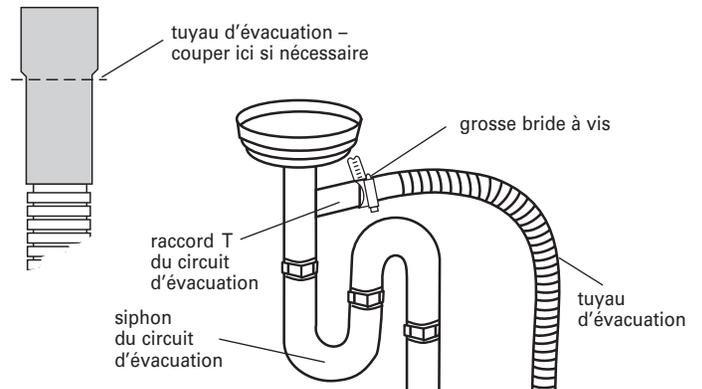
3. Insérer le tuyau d'évacuation à travers le trou découpé dans le placard et acheminer le tuyau jusqu'à l'emplacement de raccordement au lave-vaisselle.
