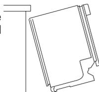
6. Insérer lentement et complètement le lave-vaisselle dans l'espace d'installation entre les placards. Veiller à ne pas coincer le tube de cuivre, le tuyau d'évacuation, le cordon d'alimentation ou le câble de raccordement direct entre le lave-vaisselle et le placard. Veiller à ne pas déformer le tube de cuivre ou le tuyau d'évacuation.
