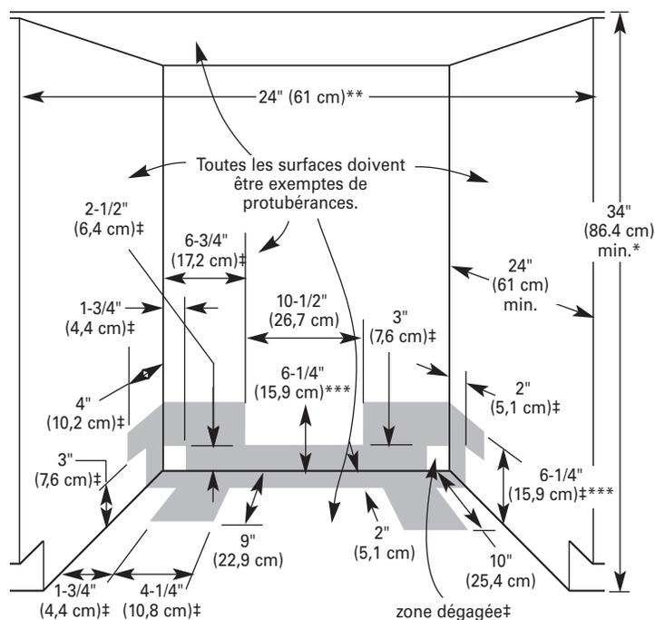
Découper les trous dans la zone marquée en gris du plancher, du mur ou des parois des placards, selon les spécifications ci-dessous :
