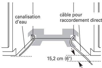
1. Vérifier que la canalisation d'eau atteint le côté avant gauche de l'espace d'installation (endroit où le raccordement à l'appareil sera effectué).
