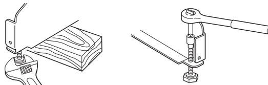
2. Vérifier que chaque pied de réglage de l'aplomb est fermement en appui sur le sol.
