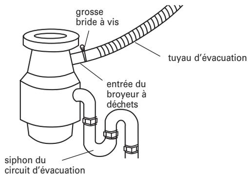
3. Insérer le tuyau d'évacuation à travers le trou découpé dans le placard et acheminer le tuyau jusqu'à l'emplacement de raccordement au lave-vaisselle.
