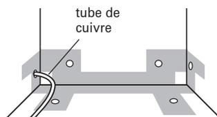
4. Enfiler doucement le tube de cuivre à travers le trou percé dans le placard. On doit travailler prudemment; le tube de cuivre est malléable et on peut facilement le déformer et même l'écraser. Vérifier que le tube de cuivre atteint le côté avant gauche de l'espace d'installation (endroit où le raccordement à l'appareil sera effectué).
