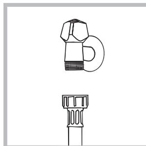
1. Sluit de toevoerbuïs aan op de koudwaterkraan met een mondstuk met schroefdraad van 3/4 gas (zie afbeelding). Voordat u de wasautomaat aansluit moet u het water laten lopen totdat het helder is.
