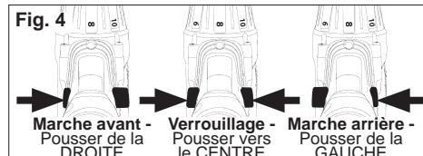
Pour une rotation **en marche avant** (dans le sens horaire), pousser le commutateur sur le côté droit de l'outil. **Vérifier la direction de rotation avant utilisation.**
