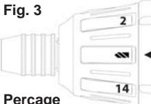
Pour régler l'accouplement, tournez l'anneau de réglage d'accouplement pour aligner la position de réglage choisie (1-15) sur la marque imprimée sur le boîtier du moteur, tel qu'indiqué. Les spécifications de couple susmentionnées sont approximatives et basées sur une batterie à pleine charge.
