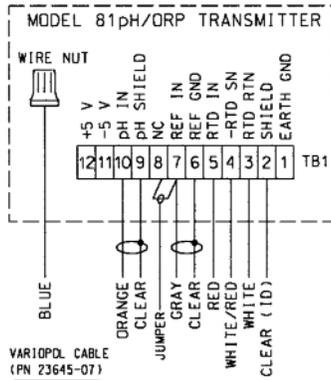
FIGURE 2-7. VP6 1181 Wiring
