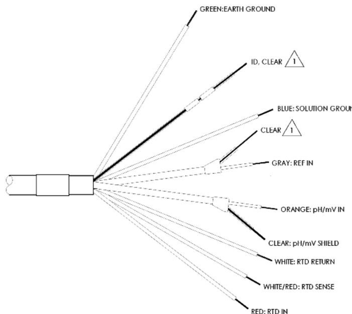
FIGURE 2-6. VP6 81 Wiring
