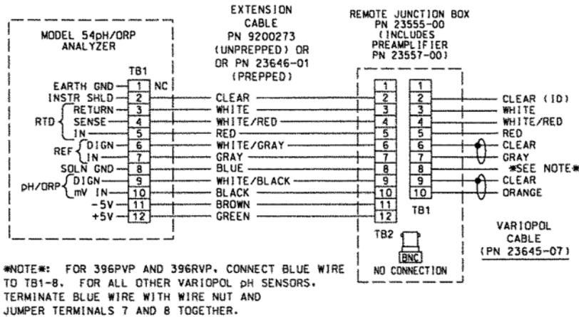
FIGURE 2-9. VP6 54 Wiring
