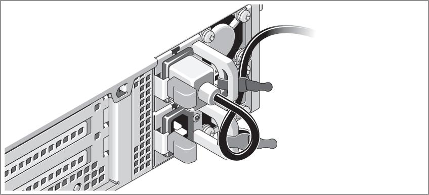
Dobre o cabo de alimentação do sistema em forma de laço conforme a ilustração e prenda-o com a tira fornecida. Conecte a outra extremidade do cabo de alimentação a uma tomada elétrica aterrada ou a uma fonte de energia separada, por exemplo, uma UPS (Uninterruptible Power Supply [Fonte de Alimentação Ininterrupta]) ou uma PDU (Power Distribution Unit [Unidade de Distribuição de Energia]).
