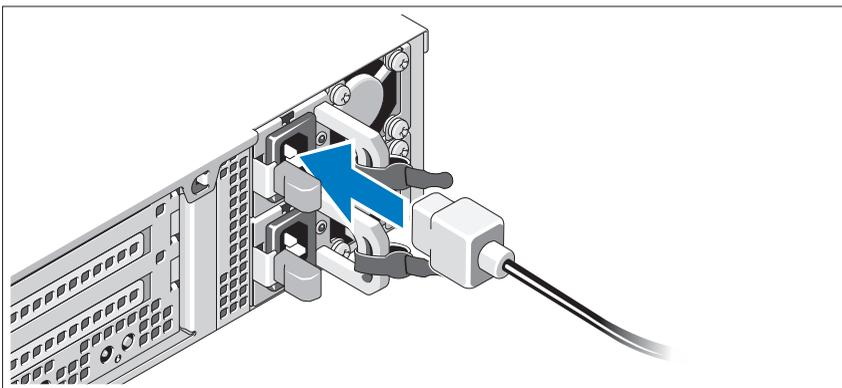
Conecte los cables de alimentación al sistema y, si se utiliza un monitor, conecte el cable de alimentación correspondiente al monitor.
