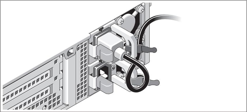
Faites une boucle comme indiqué dans l'illustration, puis fixez-le à l'aide de la sangle fournie. Branchez ensuite l'autre extrémité du câble d'alimentation sur une prise secteur mise à la terre ou sur une source d'alimentation autonome (telle qu'un onduleur ou une unité de distribution de l'alimentation).
