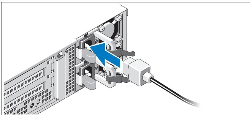
Conecte o(s) cabo(s) de alimentação ao sistema e, se for usado um monitor, conecte o cabo de alimentação ao monitor.
