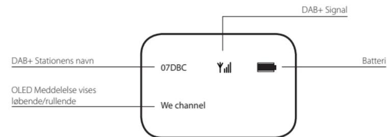
**Bemærk:** Mindre forstyrrelse kan forekomme, mens OLED er tændt. OLED vil slukke automatisk efter et kort stykke tid, og genoptage visningen ved at trykke på hvilken som helst knap.
