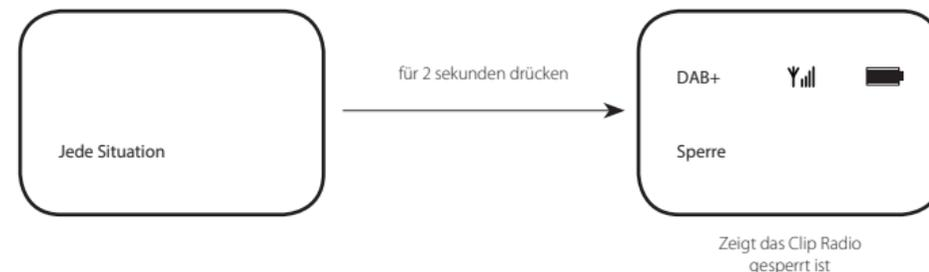
Um die Tastensperre zu deaktivieren: Drücken Sie **Volume** – für 2 Sekunden, das Wort "Sperr ab" wird in die OLED geziegt.
