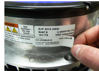
Eksempel: FCC/IC mærkaten "AM-MODBUS-W" anbringes på en ventilators hus.
