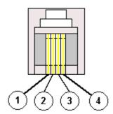
Pin 1 : Signal Input Pin 2 : Ground Pin 3 : Auto Detect
