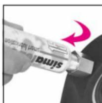
**Avvertenze:** se il lubrificatore viene attivato senza previa apertura o in caso di ostruzione dei condotti di ingrassaggio, la pressione nel lubrificatore può raggiungere circa 5 bar. Esercitando una maggiore pressione, la cartuccia entra nel contenitore e apre la camera di compressione, la pressione a monte del pistone diminuisce e il lubrificatore non può più essere utilizzato.
