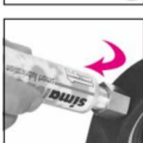
**Advertencia de seguridad:** Si el lubricador es iniciado sin abrir la salida o en caso de líneas de grasa obstruidas en la instalación, la presión en el lubricador puede subir hasta aprox. 5 bar. Con una sobrepresión el cartucho se desplaza en la carcasa y abre la cámara de presión. La presión detrás del pistón se anula y el lubricador ya no se puede seguir utilizando.
