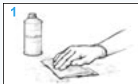
Kuva 6 Puhdista pinta. Poista kaikki epäpuhtaudet tarvittaessa liuottimella.
