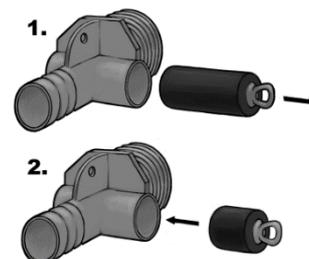
Il est nécessaire d'utiliser du ruban adhésif pour tuyau pour tous les raccords filetés sans joint, il faut de 12 à 18 tours pour que le joint soit parfaitement étanche.
