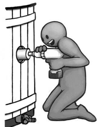
De inlaat dient dusdanig te worden gemonteerd en vastgedraaid, dat de afdichting midden in het gat past, en de twee randen ervan aan beide zijden van de kunststof wand vallen.
