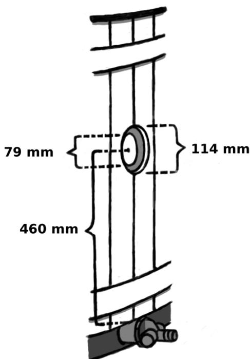
Installatie van de Kirami inlaatkit voor een kunststof hottub is zeer eenvoudig. U hoeft voor de inlaat slechts één gat te boren. In de kunststof zelf dient een gat van 79 mm Ø te worden geboord en in het houten paneel op dezelfde hoogte een gat van 114 mm Ø. Het gat in de bekleding dient groter te zijn om de inlaat vast te kunnen zetten en voldoende ruimte te hebben om de onderdelen op hun plaats te draaien.
