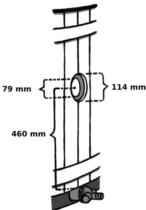
utlopp till filtret och tillbaka till inloppet. Avlägsna stickor o.dyl. när du har borrat klart hålen.
