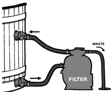
Durant l'hiver ou lorsque vous enlevez le filtre, l'orifice de retour doit être fermé avec le couvercle livré avec celui-ci.
