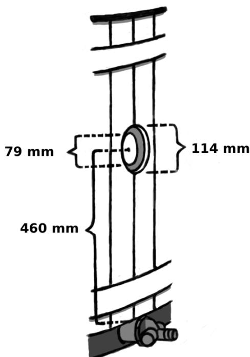
L'installation de l'ensemble du passe-cloison sur un tonneau en plastique Kirami est extrêmement simple, seul un passe-cloison requiert un forage. Il faut forer un trou de  $\varnothing$  79 mm dans le plastique et un trou de  $> \varnothing$  114 mm sur la latte en bois au même endroit. Le trou du revêtement doit être plus grand afin de pouvoir serrer le passe-cloison et permettre aux pièces de tourner.
