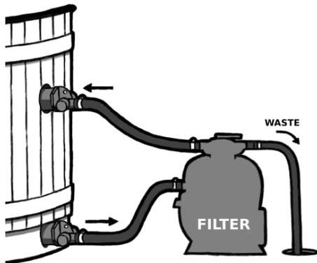
Die Anleitung für die Verbindung der Schläuche zwischen dem Filter und dem Becken liegt dem Filter bei. Links eine Übersichtsskizze der Schlauchverbindungen.
