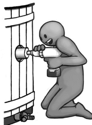
und wieder zurück ausreicht. Entfernen Sie nach dem Bohren der Löcher Splitter u. ä.
