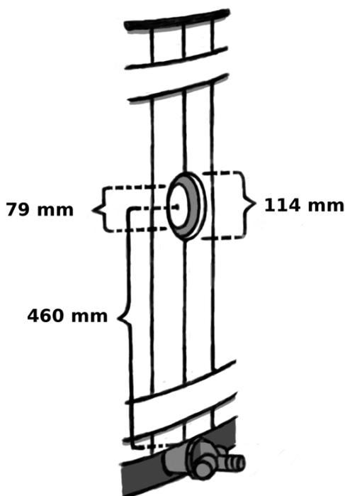
Kirami muovitynnyriin läpivientisarjan asennus on hyvin yksinkertainen, vain yhdelle läpiviennille täytyy porata reikä. Itse muoviin porataan Ø79mm reikä ja puupaneeliin samalle kohtaa >Ø114mm reikä. Verhoilussa oleva reikä tulee olla isompi jotta läpiviennin saa kiristettyä ja osat mahtuu kiertämään paikoilleen.
