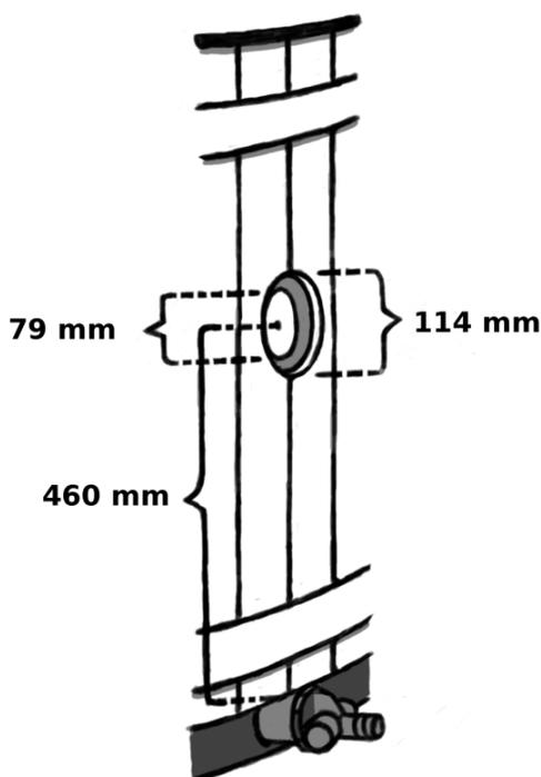
Установка проходных муфт в пластиковую бочку Kirami довольно простая, для каждого прохода нужно просверлить отверстие. В пластике требуется просверлить отверстие  $\varnothing 79$  мм и в том же месте в деревянной панели отверстие диаметром  $>\varnothing 114$  мм. Отверстие в обшивке будет больше, для того, чтобы можно было затянуть муфту и закрепить детали на место.
