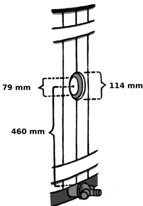
Die Installation des Zulaufsystems an das Kirami-Kunststofffass ist ganz einfach, es muss nur für eine Buchse ein Loch gebohrt werden. In den Kunststoff selbst wird ein Loch von 79 mm Ø gebohrt und in die Holzverkleidung an die gleiche Stelle ein Loch von >114 mm Ø. Das Loch in der Verkleidung sollte größer sein, damit die Buchse festgezogen werden und das Ventil verschraubt werden kann.
