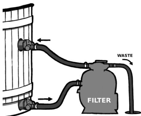
Anvisningar för anslutningen av själva slangarna mellan filtret och tunnan medföljer filtret. Till vänster visas grundprincipen för anslutningen av slangarna.
