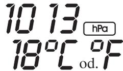
Diese Anzeige entspricht dem QNH - Wert. Ist die Höhe **A1** korrekt eingestellt zeigt die Anzeige den Luftdruck in Meereshöhe und die Temperatur. Nach 5 sek. springt die Sonderfunktionsanzeige automatisch wieder auf **A1** und Uhrzeit zurück.
