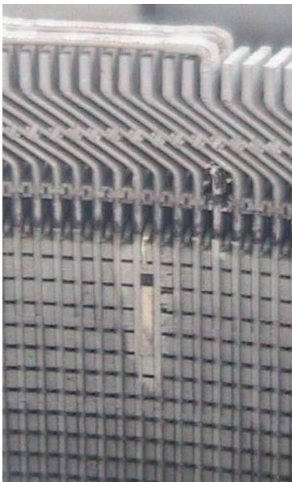
Рисунок 8: Установленный датчик воздушного зазора AGS.
