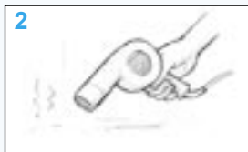
Slika 7 Osušiti površinu. Pustiti da se osuši ili ubrzati koristeći izvor toplog zraka.
