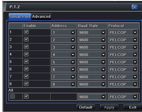
4.35. ábra P.T.Z Beállítás – soros port
