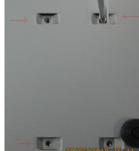
2.2. ábra HDD csavarokkal történő rögzítése a készülékházhoz
