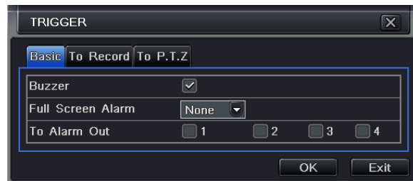
4.20. ábra Riasztások kezelése - indítójel
