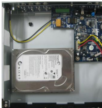
2.1. ábra HDD csatlakoztatás
