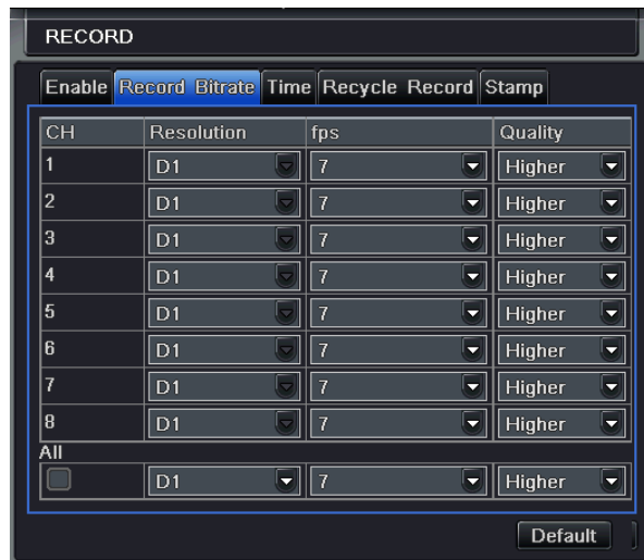
4.11. ábra Rögzítés beállítás - rögzítési sebesség
