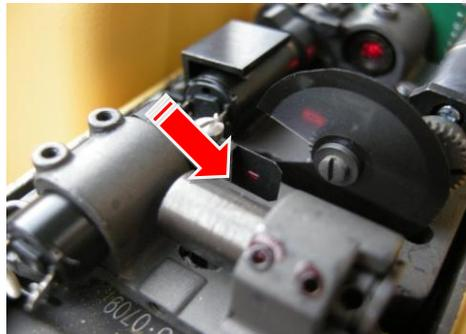
Si no es así, afloje los tornillos de corrección para ajustar la posición en el centro del láser, y apriete los tornillos, poner un poco de barniz en los tornillos de corrección.
