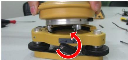
Dé la vuelta al instrumento y afloje de los tornillos en la cubierta posterior.
