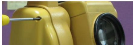
Al retirar la tapa, preste atención a los cables entre Tarjeta board de medición de Angulo y el zumbador. Desenchufe, para que pueda retirar la cubierta libremente.
