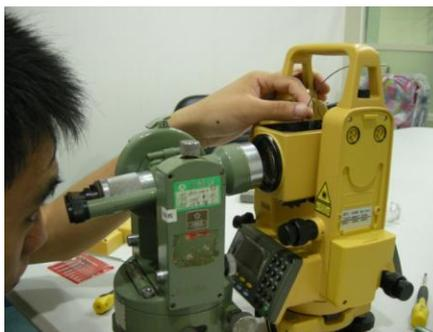
Como se muestra en la figura, debe ver una luz de punto a través del ocular del teodolito.
