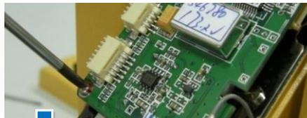
Retire los plugs con cuidado, recuerde la posición de cada plug como referencia. Retire el plug señalado cuidadosamente en la dirección de la flecha roja.
