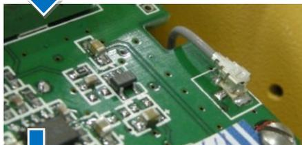
Finalizados estos pasos, al invertir la board se puede ver la fibra receptora conectada a la board de medición de distancia.
