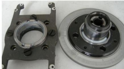
4. Ajuste la herramienta de pulido en el eje horizontal y gírelo 2.3 vueltas en sentido horario
