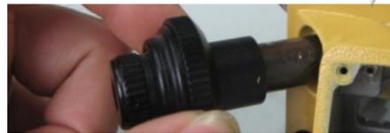
Para ensamblar la plomada óptica, nivele el instrumento en el trípode, inserte la plomada óptica en el instrumento a continuación, busque en el ocular.
