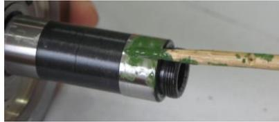
4. Ajuste la herramienta de pulido en el eje vertical y gírelo 2-3 vueltas en sentido horario
