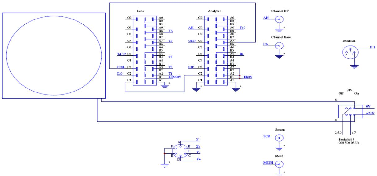
Figure 19: HSA3500 plus Wiring Backplane Q1
