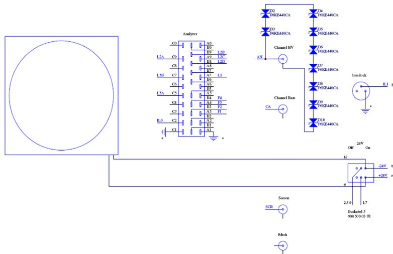
Figure 17: HSA3500 Wiring Backplane H
