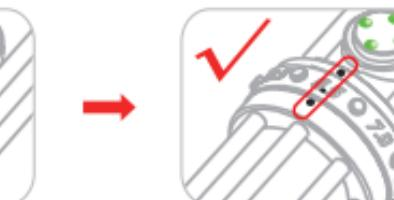
La LED rouge clignote six fois et s'éteint si la bague de réglage n'est pas correctement positionnée.
