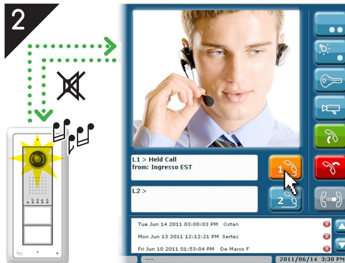
**RU** При активном вызове (рис. 1), нажмите клавишу активной линии, чтобы перевести вызов в режим ожидания (рис. 2), вызывающий (у абонентского устройства или вызывной панели) услышит мелодию.
