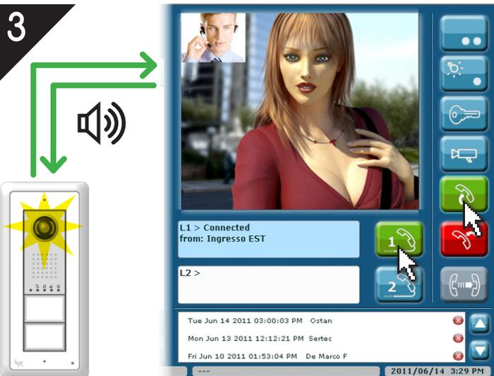
**RU** Для ответа на вызов и активации аудио связи с вызывающим пользователем нажмите клавишу "ответ" или клавишу вызываемой линии.
