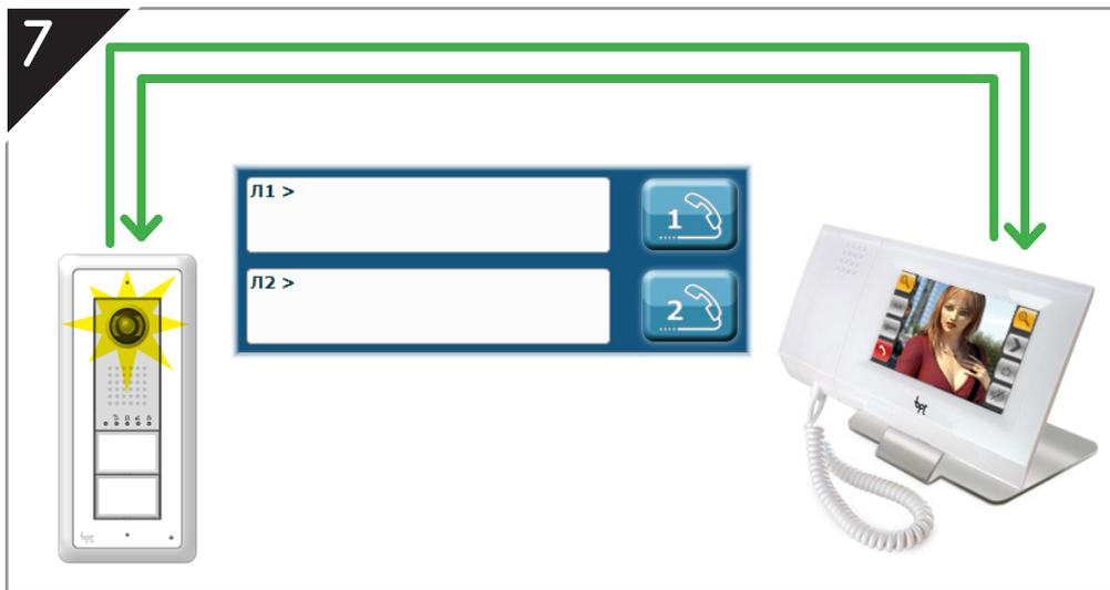
**RU** После установки соединения между вызывной панелью и абонентским устройством, линии Soft Receiver освобождаются.
