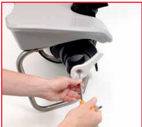
1. allentare la vite della leva di controllo
