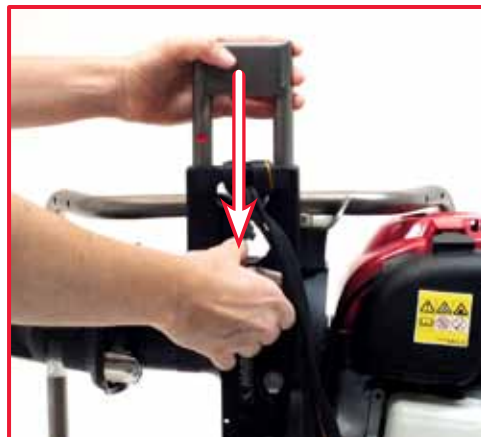
2. tirare il morsetto e innestare il tubo frontale corto nell'apposita sede
