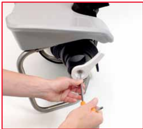
3. serrare la vite della leva di controllo
