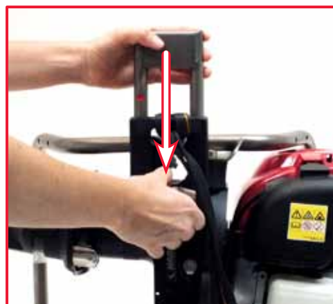
4. tirare il morsetto e innestare il tubo frontale corto nell'apposita sede
