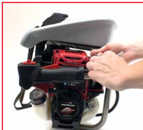
2. svitare le 4 viti che fissano la seduta al telaio con una chiave a brugola n°5
