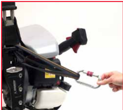
Controllare l'integrità della fettuccia e del moschettone.
