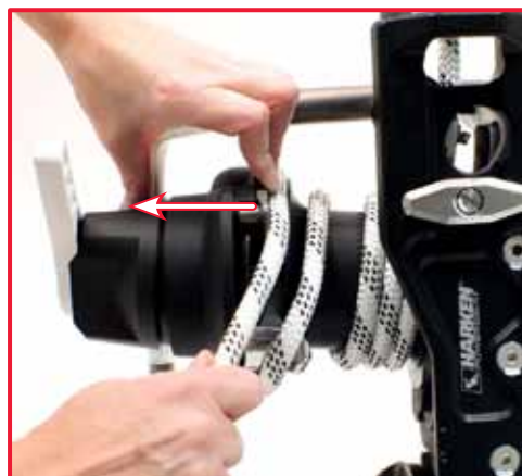
10. far passare la fune fra le due semipulegge. Per agevolare l'operazione sollevare il coperchio
