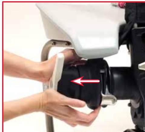
Verificare la mobilità del coperchio delle semipulegge.
