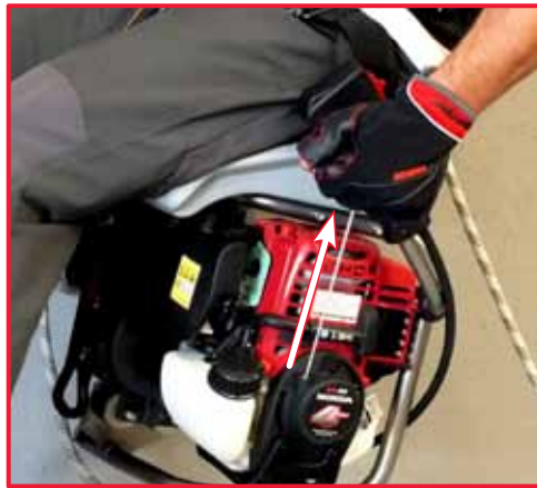
7. tirare la fune di accensione del motore
