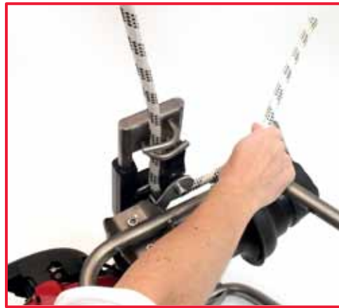
6. infilare la fune attorno alla puleggia
