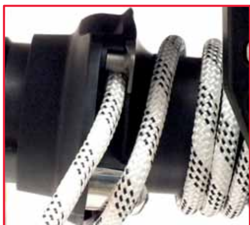
11. posizionare la fune all'interno del fermo
