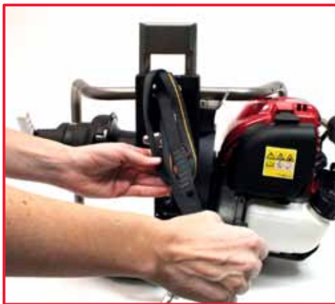
5. sfilare la fettuccia dal punto di ancoraggio superiore
