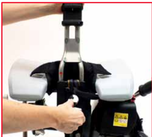
1. tirare il morsetto e sfilare il tubo frontale
