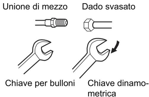
Un serraggio eccessivo senza eseguire una centratura accurata può danneggiare le filettature e provocare perdite di gas.
