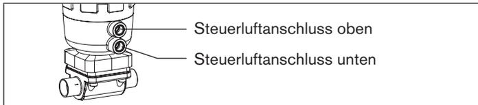
Bild 16: Pneumatischer Anschluss
