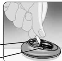
**⚠ AVVERTENZA:** per evitare possibili scosse, non cambiare l'una o l'altra batteria quando lo strumento è collegato ad un PC con cavo d'interfaccia OneTouch®.
