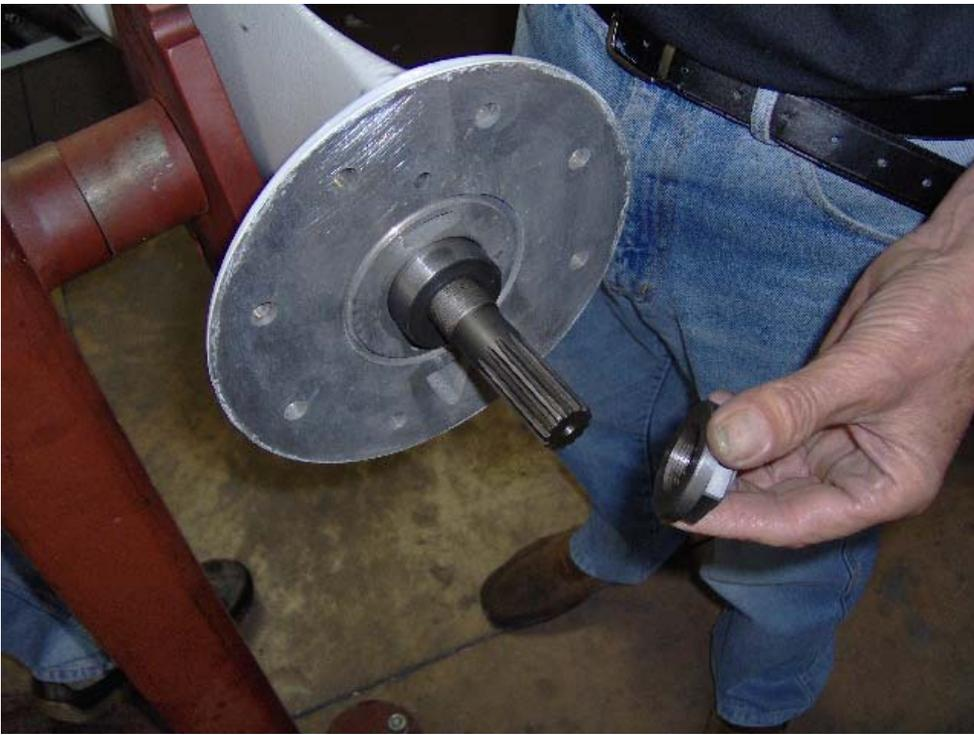
Insert bearing ( rif. n° 62), insert and screw lock nut ( rif. n° 61)
