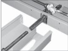
Die beiden Traversenteile am Wellenadapter zusammenstecken.
