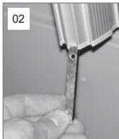
Gewindeschlitten in die Nuten der Längsseiten vorne und hinten einführen und Fußausleger in entsprechender Höhe wieder festklemmen.
