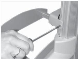
...und durch Anziehen der Kunststoff-Gewindestifte (Pos. 10\*) in die Profiltut oberhalb der Fußelemente klemmen.
