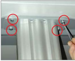
Tischplatte auf die Plattenaufgaben legen und mit je vier Schrauben (Pos. 24\*) an den Säulen befestigen.
