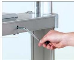
Kurbel in das Innensechskant an der Quertraverse stecken.
