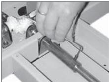
Gleichlaufwelle und Wellenadapter durch Einschrauben des Gewindestiftes (Pos. 15) mit einem Innensechskantschlüssel SW3 gegen Verdrehen sichern.
