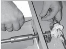
Gestellteile mit 4x Schrauben (Pos. 13\*) und 4x Muttern (Pos. 14) mit Innensechskantschlüssel SW3 und Schraubenschlüssel SW8 verbinden.
