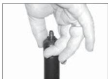
**06** Gasfeder gegen den Uhrzeigersinn herausdrehen und durch eine neue ersetzen.
