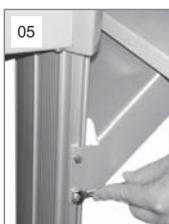
Druckerbord in gewünschter Höhe positionieren und Gewindestifte jetzt festziehen. Mit je 2 Muttern (Pos. 3) kontern.
