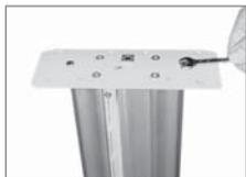
**02** 2 Sechskant-Einstellschrauben SW8 (für die unteren Führungsrollen) lösen und herausnehmen.
