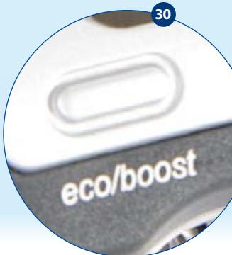
Als u de aan/uit knop hebt ingedrukt, en het systeem hebt ingeschakeld, start het systeem automatisch op in de "eco" stand. Als u echter met boost ondersteuning wilt fietsen drukt u 1 keer op de eco/boost knop. Wilt u weer terug schakelen naar eco, dan drukt u nogmaals op deze eco/boost knop. Deze knop heeft geen functie als u de trapbekrachtiging niet eerst heeft aangezet via de aan/uit knop (1).
