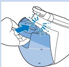
**2** Repositionnez correctement le réservoir d'eau sur la centrale (clic).
