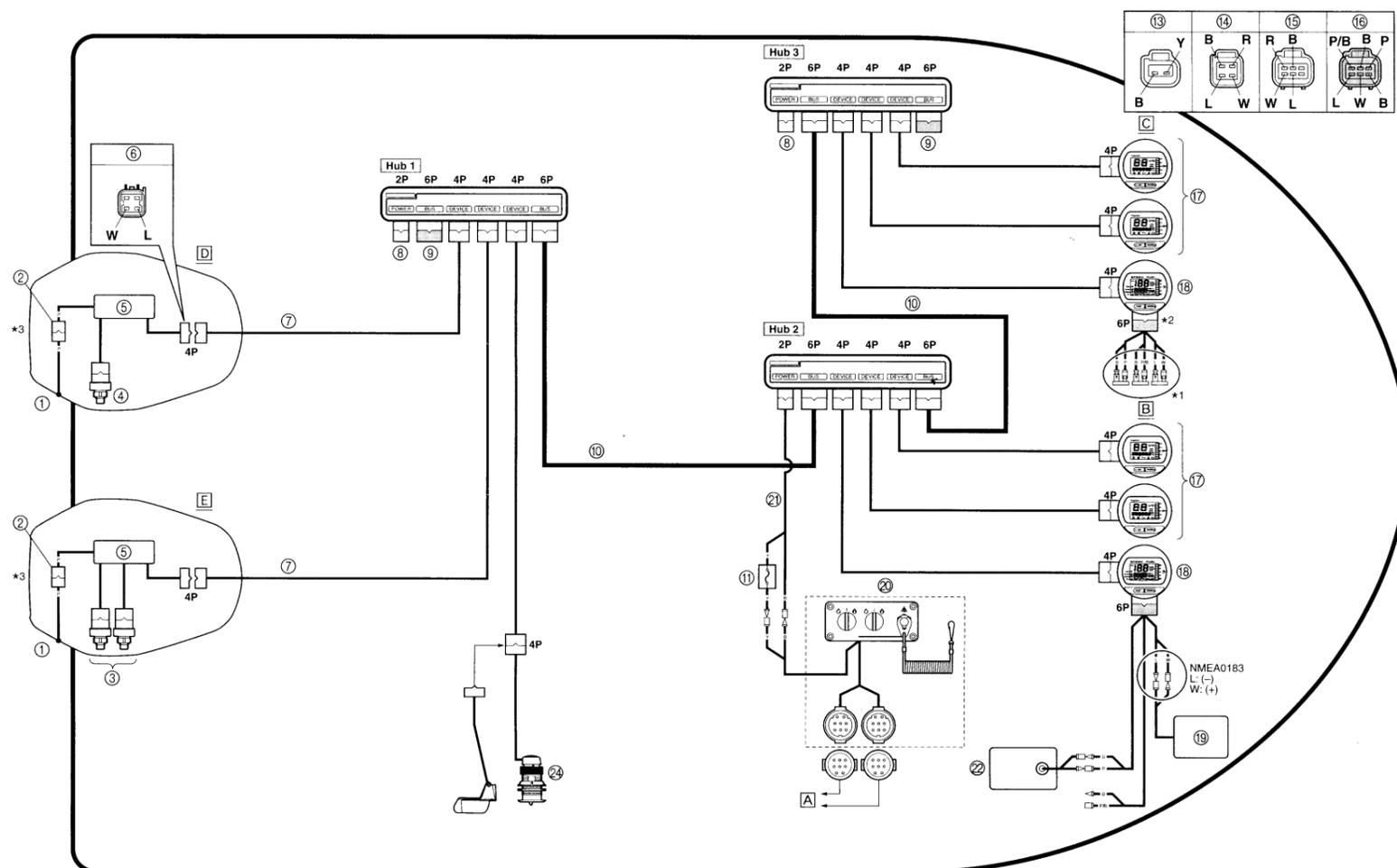
\*1: Cuando instale varios velocímetros o indicadores de velocidad y gasolina, la unidad GPS y los sensores del depósito de combustible sólo se tienen que conectar a un indicador. En tal caso, no quite las tapas impermeables de los conectores del otro indicador.
