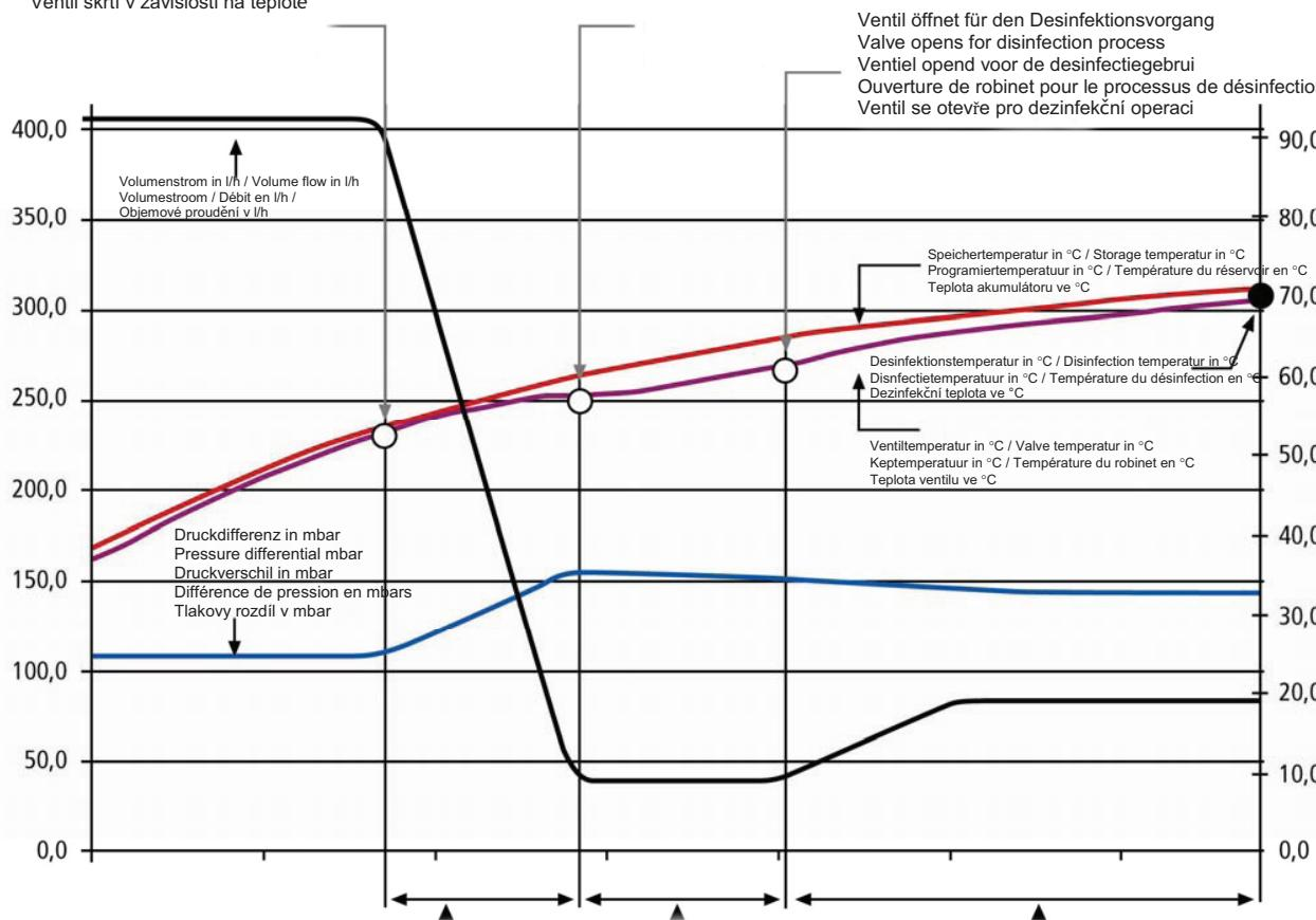
**D** Zwischen 52 °C und eingestelltem Sollwert werden Drosselstellungen temperaturabhängig eingestellt.
