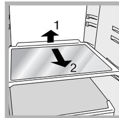
**ABLAGEN:** glattflächig oder in Gitterform. Sie können herausgezogen und dank entsprechender Führungen (siehe *Abbildung*), höhenverstellt werden, um auch große Behälter unterbringen zu können. Zur Höhenverstellung ist es nicht erforderlich, die Ablage
