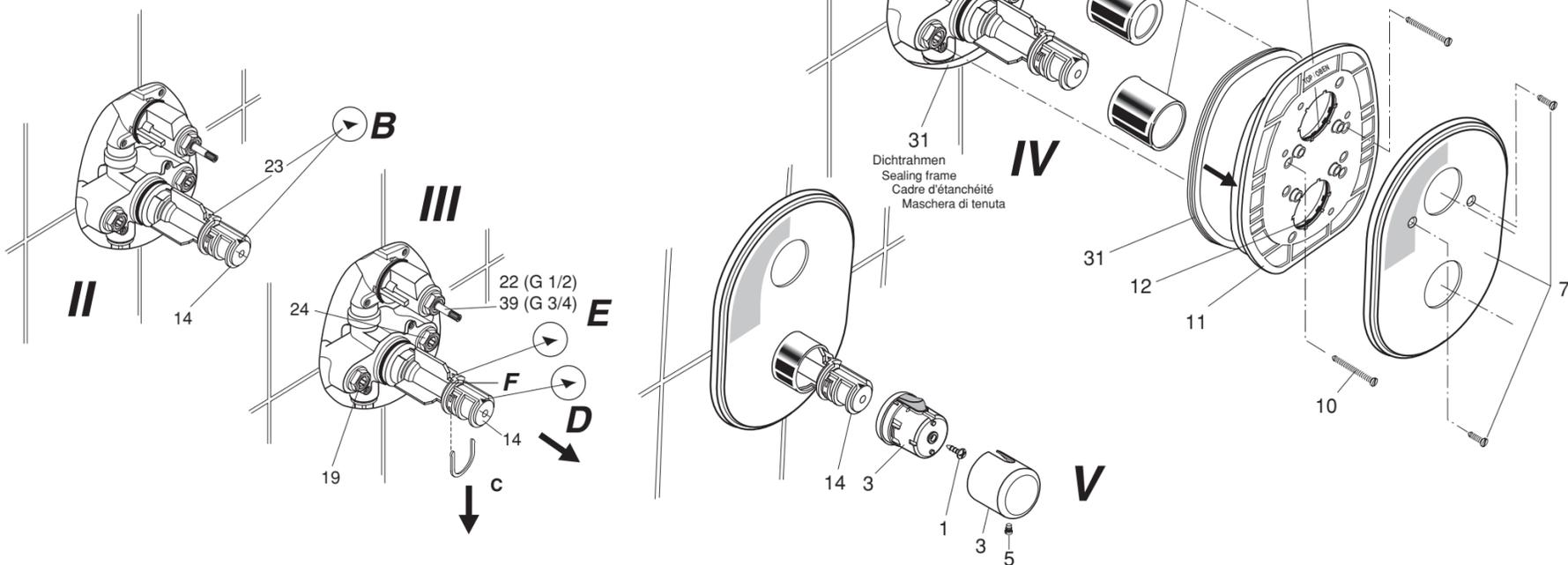
■ Abdeckkappen 13 aufschieben (bis über den O-Ring, siehe Bild IV). Rosettenhalter 11 mit leicht eingefetteten O-Ringen 12 über die Abdeckkappen und in den Dichtrahmen 31 schieben und mit Schrauben 10 befestigen. Rosette 7 aufsetzen und mit den Schrauben befestigen.
