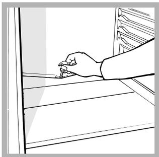
Der Kühlschrank taut automatisch ab: Das Tauwasser wird nach hinten durch eine kleine Ablaufoffnung (*siehe Abbildung*) abgeleitet, wo es dank der vom Kompressor erzeugten Wärme verdampft.
