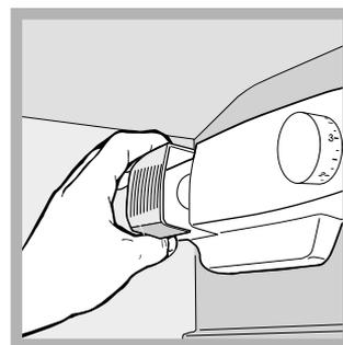
Öffnen Sie die Lampenabdeckung wie auf der Abbildung veranschaulicht. Ersetzen Sie die Lampe durch eine neue derselben Leistung und Bauform (auf der Schutzabdeckung angegeben)(10 W oder 15 W).
