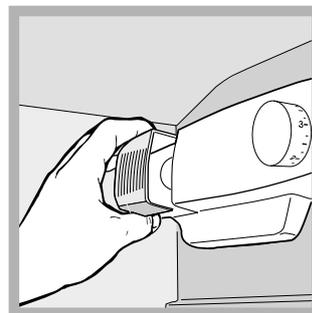
Pour pouvoir remplacer l'ampoule, démontez le couvercle de protection comme illustré (voir figure). Remplacez-la par une ampoule semblable dont la puissance doit correspondre à celle indiquée sur le couvercle de protection (15 W ou 25 W).
