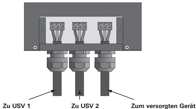
1. Schließen Sie die Netzkabel an zwei USV an (USV1 (S1) ist die bevorzugte Stromquelle).
