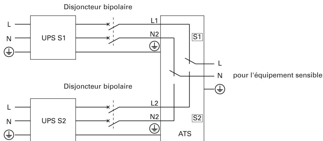
Après le raccordement électrique, l'Eaton ATS effectue automatiquement un autotest de mise sous tension. Une fois le test terminé, l'Eaton ATS commence à alimenter son équipement connecté. Vous pouvez également appuyer sur le bouton de test pour forcer l'Eaton ATS à exécuter un autotest.
