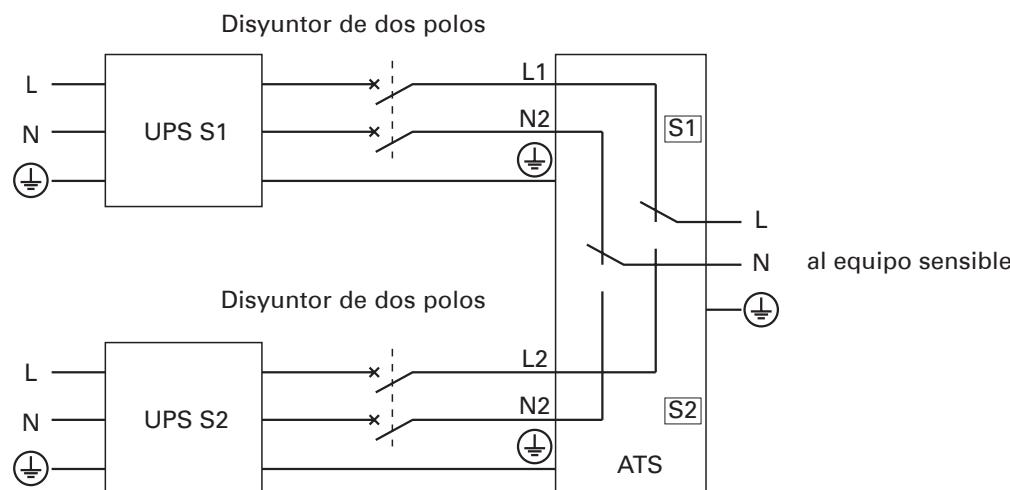
Después de conectar el suministro eléctrico, el Eaton ATS lleva a cabo automáticamente una prueba de encendido. Tras la prueba, el Eaton ATS comienza a suministrar energía al equipo conectado. También puede pulsar el botón "Test" (prueba) para forzar al Eaton ATS a ejecutar una prueba automática.
