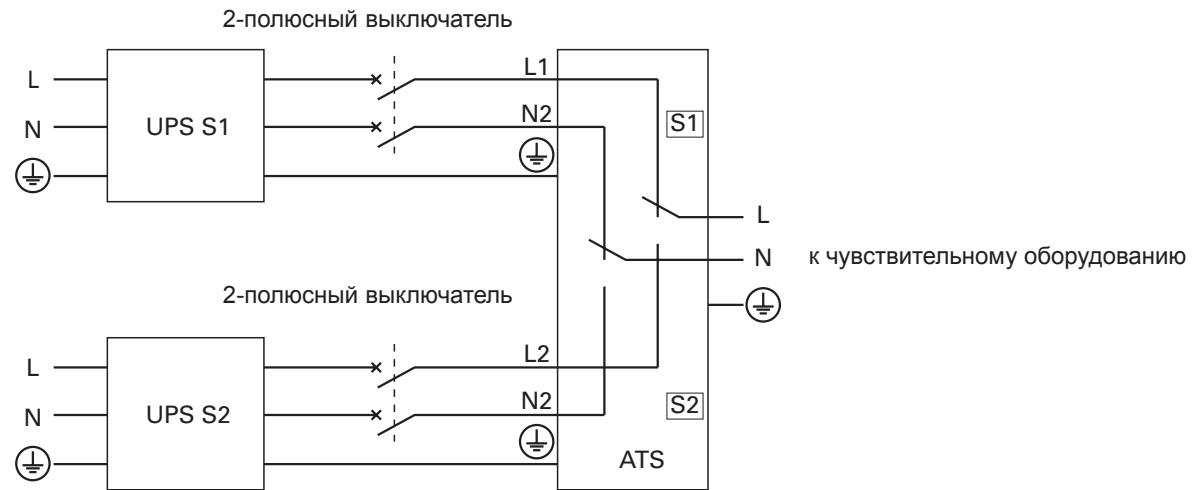
После подключения к сети энергоснабжения устройство Eaton ATS автоматически запускает процедуру самопроверки при включении питания. После завершения проверки устройство Eaton ATS начинает подавать питание на подключенное оборудование. Для принудительного запуска самопроверки Eaton ATS можно нажать кнопку «Test Button».
