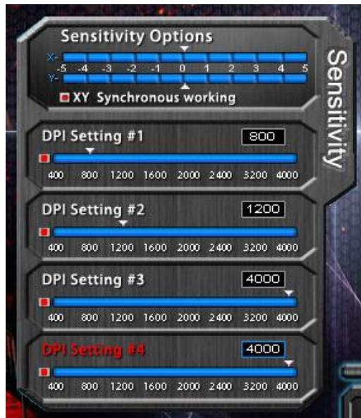
**Sensitivity options** – używając suwaków możesz ustawić czułość dla X oraz Y jednocześnie (gdy okienko *X/Y synchronous working* jest zaznaczone) bądź osobno (jeśli jest odznaczone).
