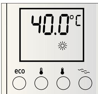
Wird die eingestellte Temperatur auf Grund eines zu hohen Wasserdurchflusses nicht erreicht, reguliert der Durchlauferhitzer automatisch den Wasserausfluss, bis die eingestellte Temperatur erreicht ist.
