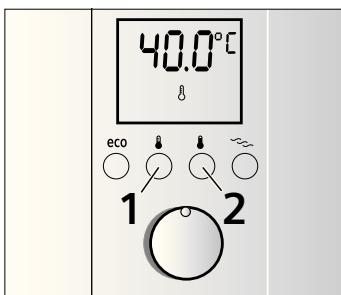
Przycisk indywidualnej temperatury **1** ma wstępne ustawienie 40°C, a przycisk indywidualnej temperatury **2** ma ustawienie 60°C.
