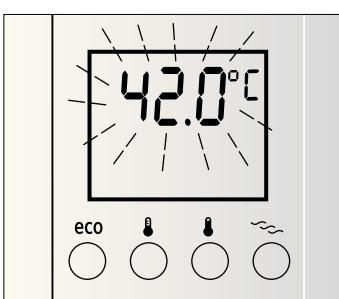
De doorstroomgeiser kan met voorverwarmd water (bijvoorbeeld uit zonne-energie) worden gebruikt. Als de toevoertemperatuur meer dan 30°C is, brandt in het display ⚡.
