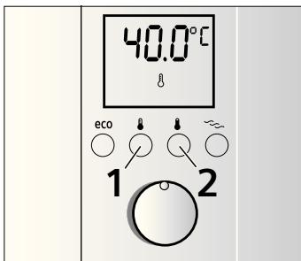
De toets voor de gewenste temperatuur **1** is vooraf ingesteld op 40°C. De toets voor de gewenste temperatuur **2** is vooraf ingesteld op 60°C.
