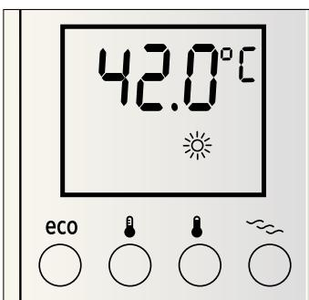
Als de ingestelde temperatuur vanwege een te hoge waterdoorstroming niet wordt bereikt, regelt de doorstroomgeiser automatisch de wateruitstroom tot de ingestelde temperatuur bereikt is.
