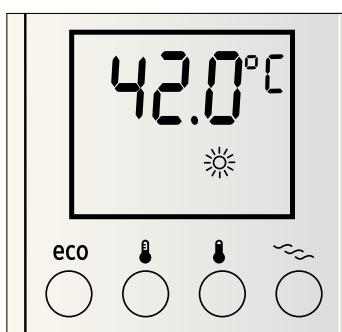
Jeżeli ze względu na zbyt wysoki strumień przepływu wody nie jest osiągana ustawiona temperatura, to podgrzewacz przepływowaty automatycznie ogranicza wypływ wody aż do momentu osiągnięcia ustawionej temperatury.
