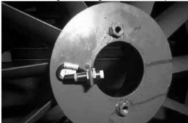
Picture 16 Fan speed sensor
