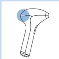
Sobald alle Kontaktschalter des Sicherheitsrings Kontakt zur Haut haben und das Gerät aufgeladen ist, leuchtet die Bereitschaftsanzeige auf der Geräterückseite grün.
