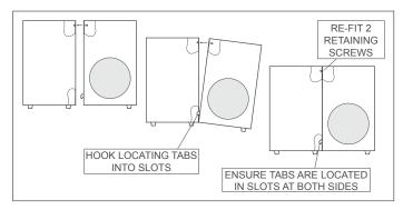
TEST THE HEATER ONCE RE-CONNECTION HAS BEEN COMPLETED
