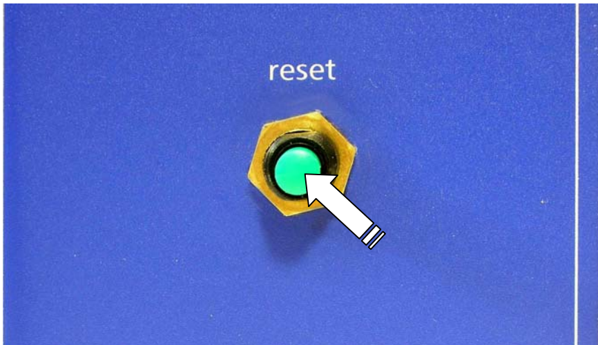
Bild 3.9.2. green button to reset the alarm
