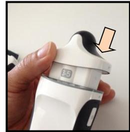
**Abb. 2.7 Einsetzen des Schallkopfs**
