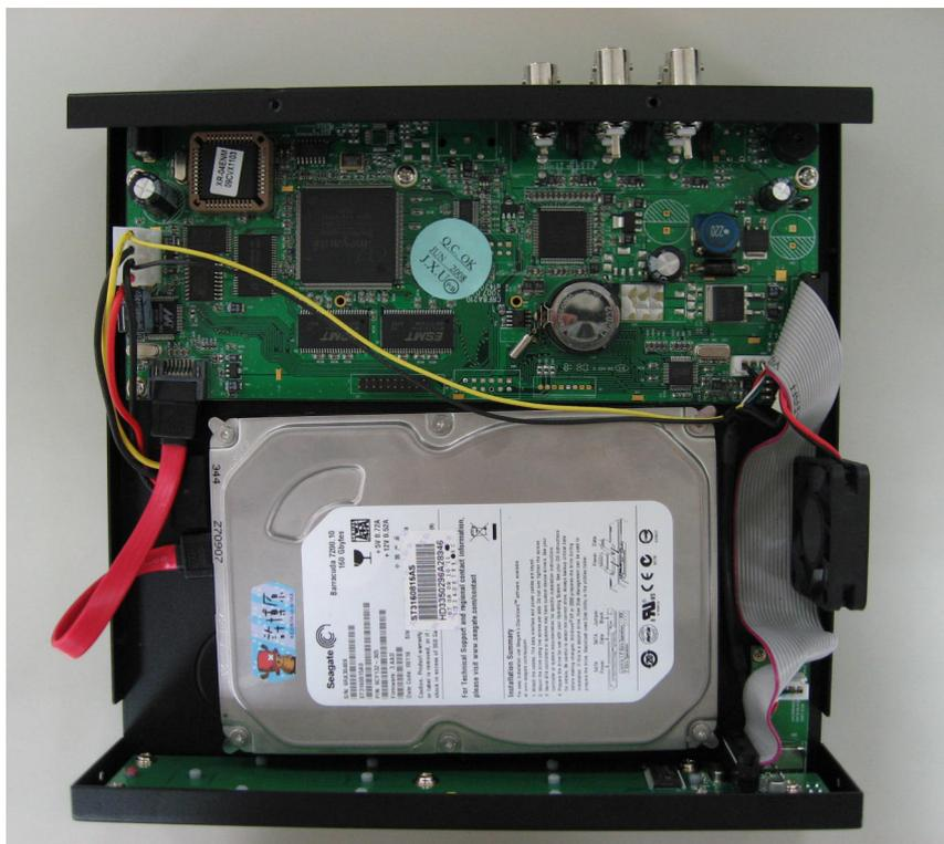
3. 並由機器的下方四個孔鎖緊硬碟，如下圖所示位置。螺絲附在附件包，
