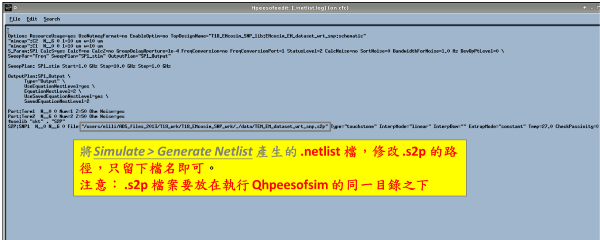
圖 2.2-2 產生的 netlist，需修改 .s2p 的路徑
