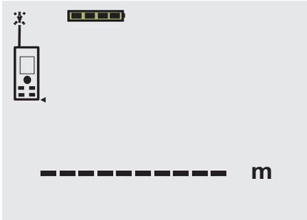
瞄準標的。再按一下"Measure" (測量) 按鈕測量距離。測量結果通常會於1秒內顯示於結果列，然後雷射光束便自行關閉。
