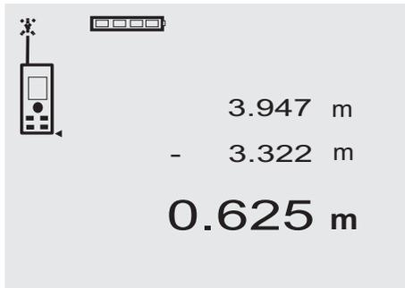
經由彼此扣減，很方便地便可計算個別距離，例如當用在測定管線底部到天花板間的距離時。將地板到天花板的距離和地板到管線底部的距離相減即可。如果減去管線直徑，則為管線頂端到天花板的距離。
