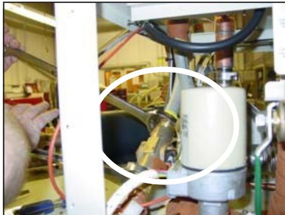
4. Remove the bottom Swagelok.
