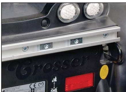
De medföljande glidmuttrarna körs in i c-skenan.
