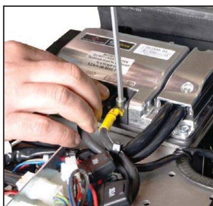
Kontakterna från batteriet återmonteras, men inte hårt.
