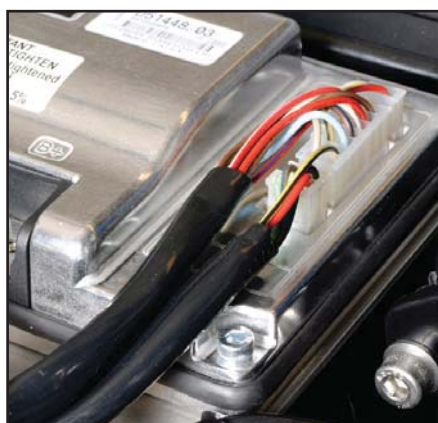
Lossa kontakterna från motorn.
