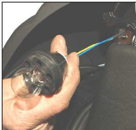
På 4W kan man lossa glödlampan och dra ut den för att byta den, utan att montera av skärmen.
