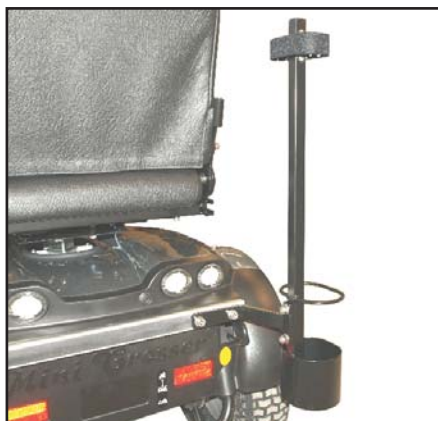
Anpassa listens längd. Montera kähphållaren i C-skenan. Montera spärren igen.
