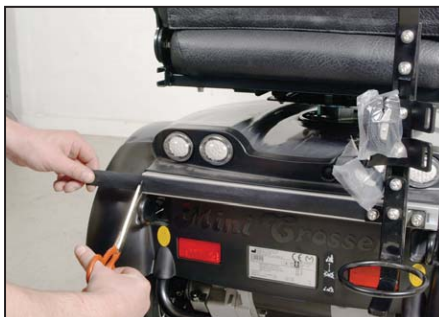
Gummiremsan tillpassas i längd på båda sidor om syrgashållaren.
