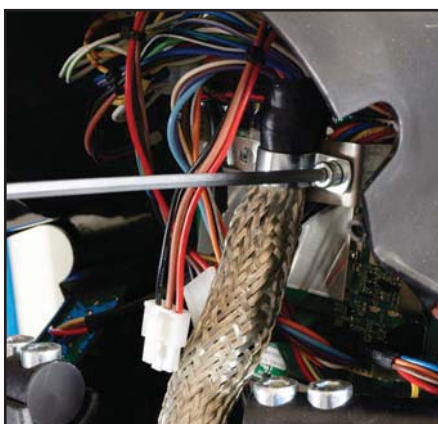
Ta loss bygel som håller huvudkabeln på plats.
