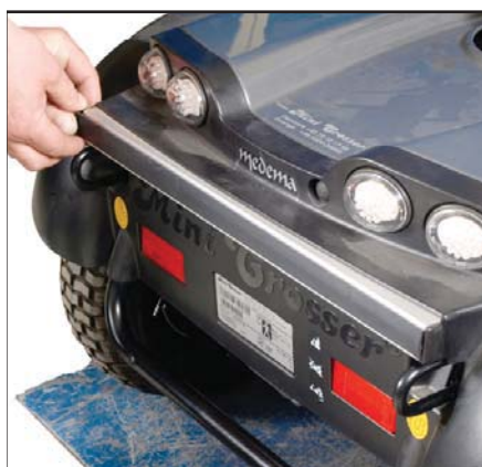
Gummlist och ändpropp återmonteras.
