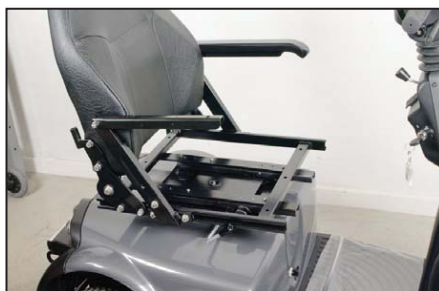
Sätt sätet på fordonet och sätt i kontakten. Kontrollera att sätet kan köra fram/tillbaka.
