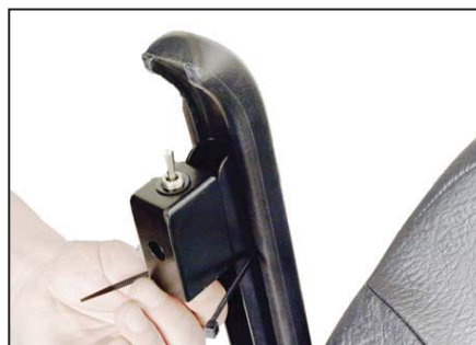
Kontakten monteras med gummibälg och muttern.
