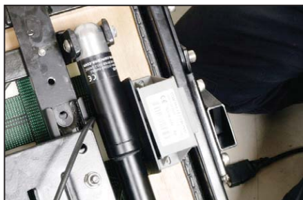
och montera el-boxen på träplattan. Stripa upp ledningarna.
