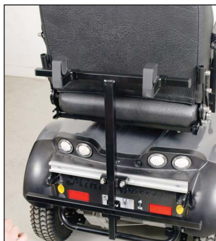
Rollatorhållaren skruvas fast med de medföljande skruvarna och placeras på mitten av skenan.
