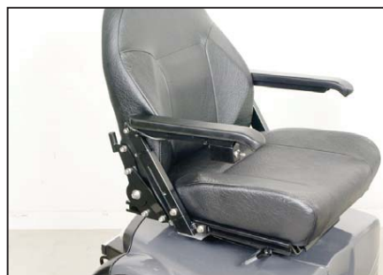
Montera sticket under sätet med sticket från kontakten. Kontrollera att el-sätet fungerar som det ska.
