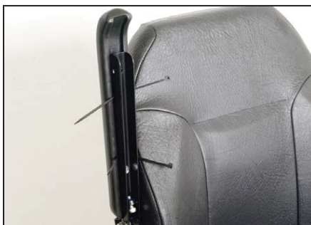
Avmontera den yttersta skruven under armstödsdynan och pressa in två buntband för fäste av kabel.
