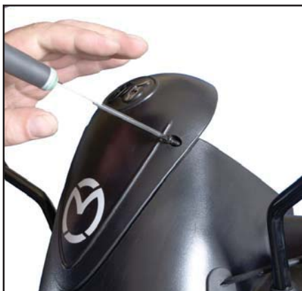
Stäng av scootern genom att vrida av nyckeln. Montera av skyddskåpan.
