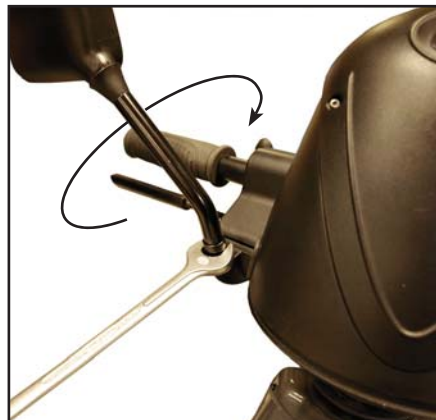
Skruva fast sidespegeln genom att vrida hela spegeln medurs. Ställ in rätt vinkel och dra emot med skruvnyckel storlek 17.
