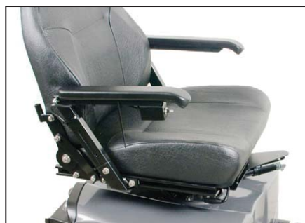
Montera kontakten under sätet med kontakten från vippkontakten. Kontrollera att sätet fungerar som det skall.
