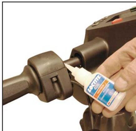
Använd Loctite 406 vid montering av gashandtaget.
