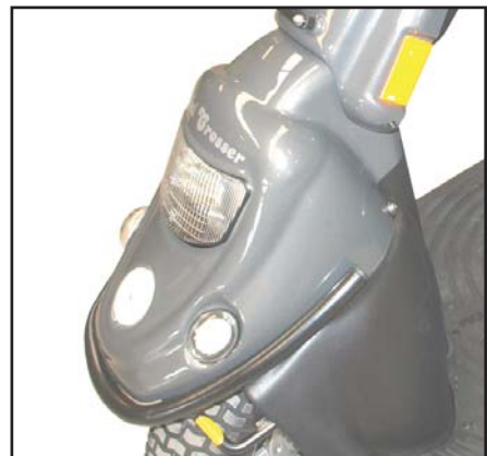
På 3W ska framskärmen monteras av innan man kan byta glödlampan.
