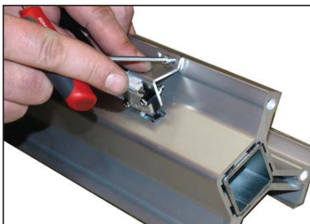
Montera switchen i de förborrade hålen.
