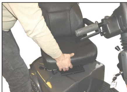
Sätt tillbaka sätet. Tänk på att stå rätt med ryggen, då sätet är tungt.
