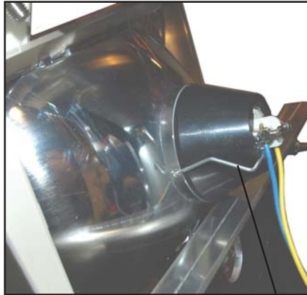
Framlyktans glödlampa sitter fast med en bygel.
