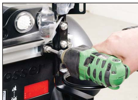
Fäst därefter syrgashållaren med de medföljande skruvarna. Innan skruvarna dras åt, skjut hållaren till önskad plats.
