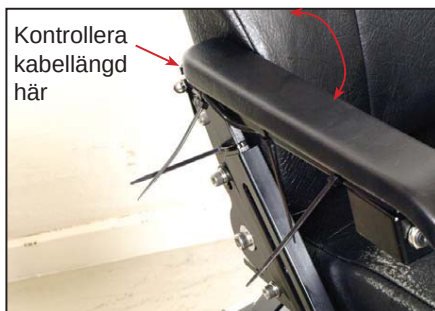
Kabeln stripas upp. OBS!: ge nog kabel till att Armstödet kan föras ohindrat upp och ned innan det stripas.
