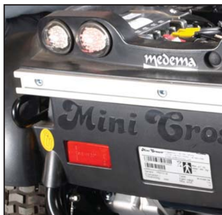
Bakplattan och kontakterna återmonteras.
