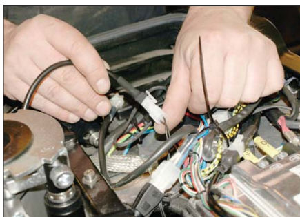
Pos 3 Monteras med lös 2-polig kontakt.
