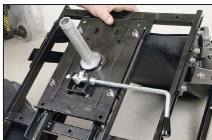
Montera sätesunderdelen till EI-sitsglidning fram/tillbaka..
