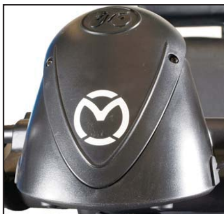
Styrhuvudet och skyddskåpan monteras igen.
