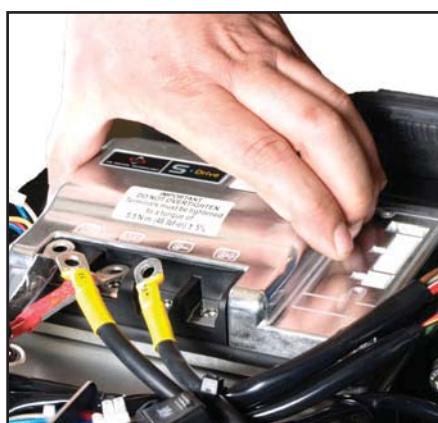
Återmontera ny elektronikbox och montera skruvarna.
