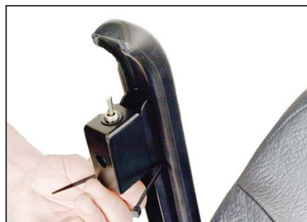
Kontakten monteras med gummibålg och omlöper.
