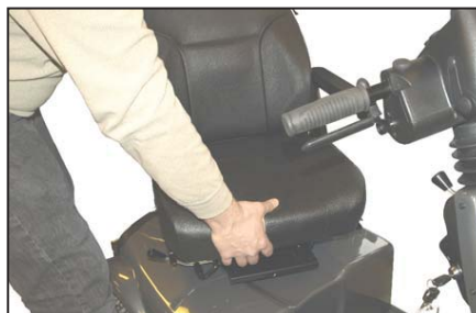
Lyft av sätet. Tänk på att stå rätt med ryggen, då sätet är tungt.
