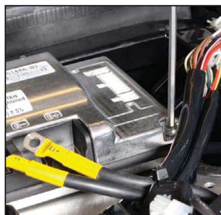
Nu kan elektronikboxen skruvas loss och bytas ut.
