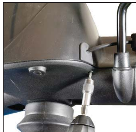
Montera av instrumentpanelen.
