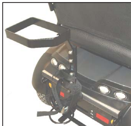
På samma sätt monteras hållare för syreapparat.
