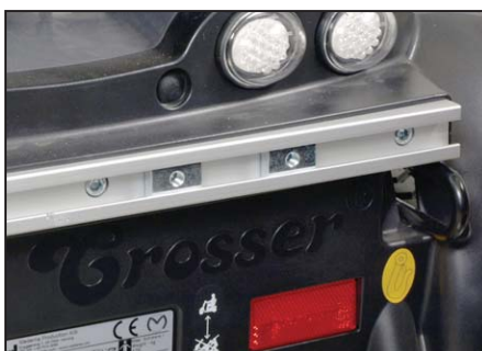
De medföljande glidmuttrarna körs in i C-skenan.
