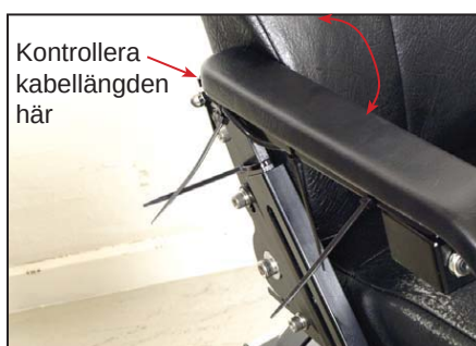
Kabeln strippas åt med buntband. Var noga med att ge kabel när den fästes, så att armstödet kan fällas upp och ned utan problem.
