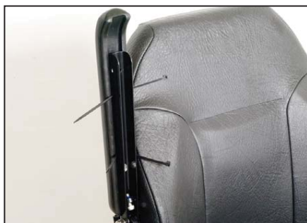
Avmonerar den översta skruven på armstödet och pressa 2strips in till uppstrippningen av kabeln.
