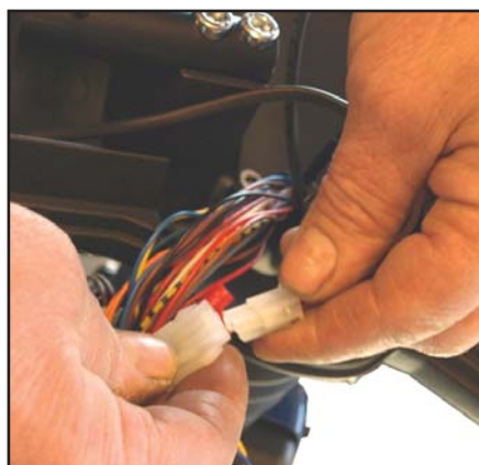
Anslut vridgasreglaget till den 3-poliga kontakten där standardpotentiometern var ansluten.
