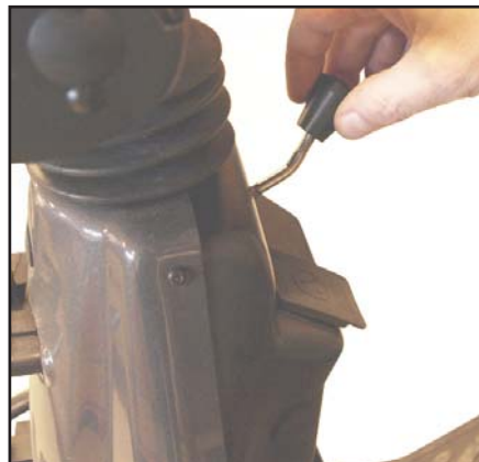
Ta av plasthandtaget från gasfjäderutlösaren.
