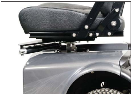
Montera kontakten under sätet med kontakten från batterierna. Kontrollera att el-sätet vrider som det skall.
