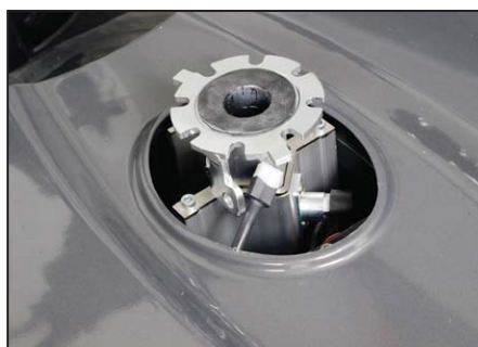
Byt ut sitsröret till det medskickade. Dra det upp och ner så att det fastnar i ett håll.
