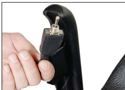
Innan kontakten monteras i boxen, kontrollera då att ner = framåt och upp = tillbaka.
