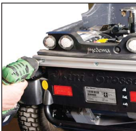
Demontera den ena ändproppen och lossa gummilisten. Lossa de tre bultarna som håller bakplattan.
