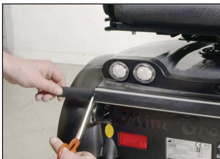
Rollatorhållaren skruvas fast med de medföljande skruvarna och placeras på mitten av skenan.
