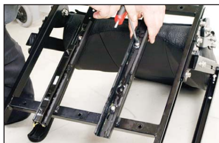
Montera medföljande glidskena utan handtag.
