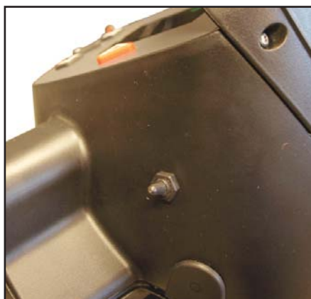
Montera kontakten så att den pekar åt rätt håll. Montera instrumentpanelen. Undvik att klämma/sträcka ledningarna.
