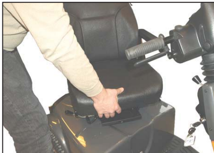
Lyft av sätet. Tänk på att stå riktigt med ryggen, då sätet är rätt tungt.
