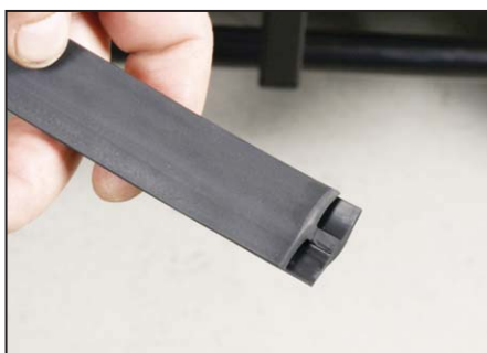
Baksidan av gummiremsan klipps av ca, 5mm. Detta för att få en snygg avslutning.
