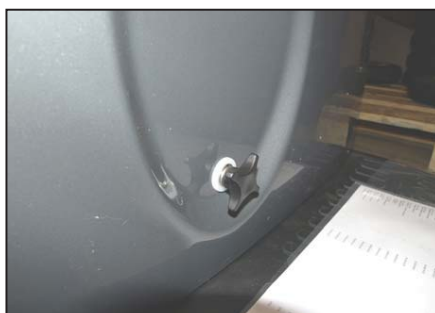
Skruva av fingerskruven och lyft av batterikåpan.
