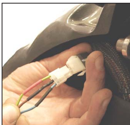
Gaspedalens kabel dras genom hålet och upp vid styrstången. Den medföljande kontakten monteras så som visas ovan. Skoterns uttag (nr. 4) för gaspedal dras fram (ligger under den främre skärmen) och monteras med gaspedalen.
