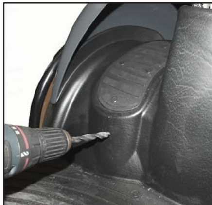
Avgör var gaspedalen ska monteras. Borra ett 13 mm hål för pedalens kabel. För igenom den medföljande gummigenomföringen.
