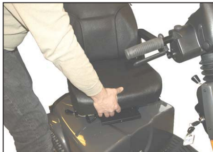
Lyft av sätet. Tänk på att stå rätt med ryggen, då sätet är tungt.
