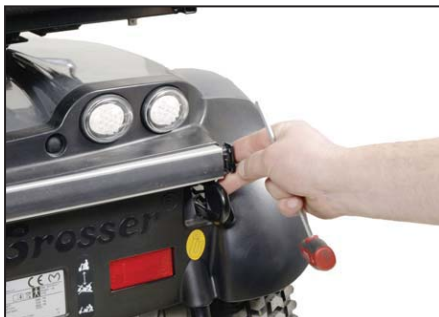
Ta av ändproppen. Använd eventuellt en skruvmejsel för att lossa den.
