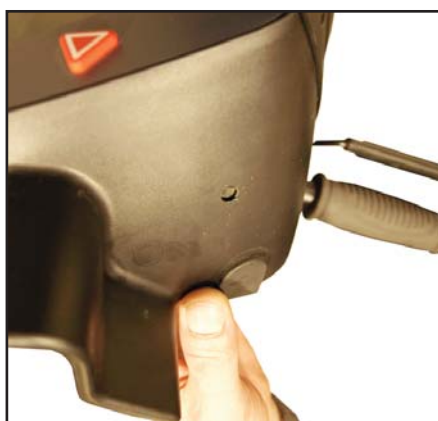
Borra ett hål som är 6,5 mm. Placeras enligt bilden.
