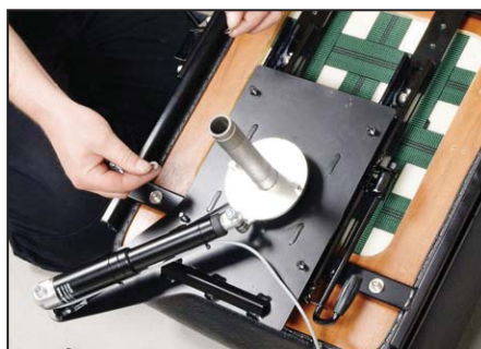
Montera bottenplattan till el-sitsvridningen.
