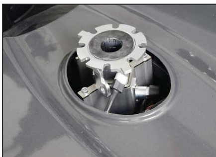
Montera tillbaka batterikåpan och se till att kontakten går att nå.
