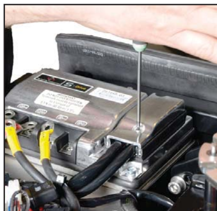
Montera av kåpan
