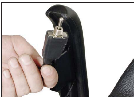
Innan kontakten monteras i boxen, kontrollera att vipparmen går åt önskat håll.
