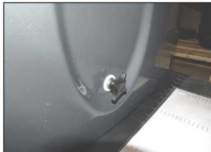
Skruva av fingerskruven och lyft av batterikåpan.
