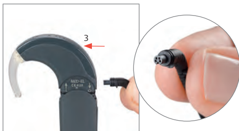
Fig. 15 Isättning av spolens sladd i processorenheten.
