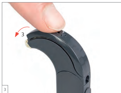
Fig. 20 Borttagning och ditsättning av mikrofonhöljet
