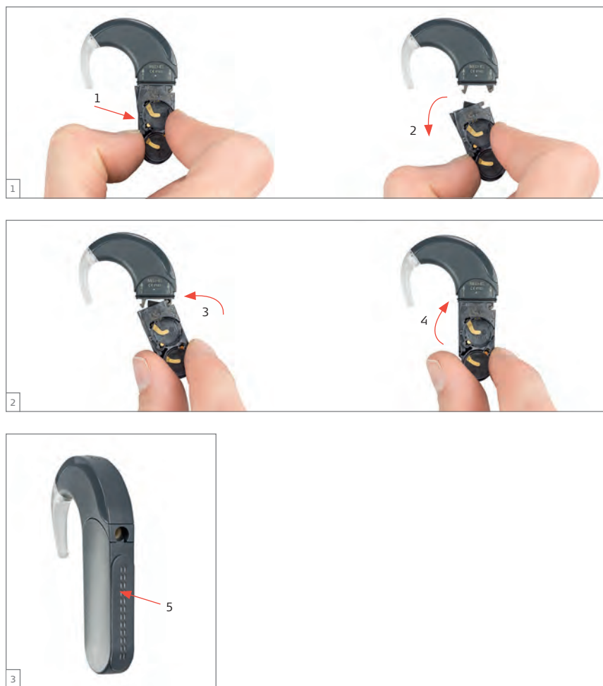
Fig. 8 Hur batterihållaren tas bort från och sätts ihop med processorenheten
